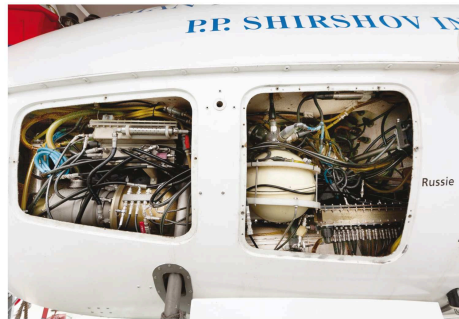
Une fois enlevés les panneaux qui les masquent, les trappes d'accès aux entrailles du sous-marin donnent une idée de sa complexité technique.
