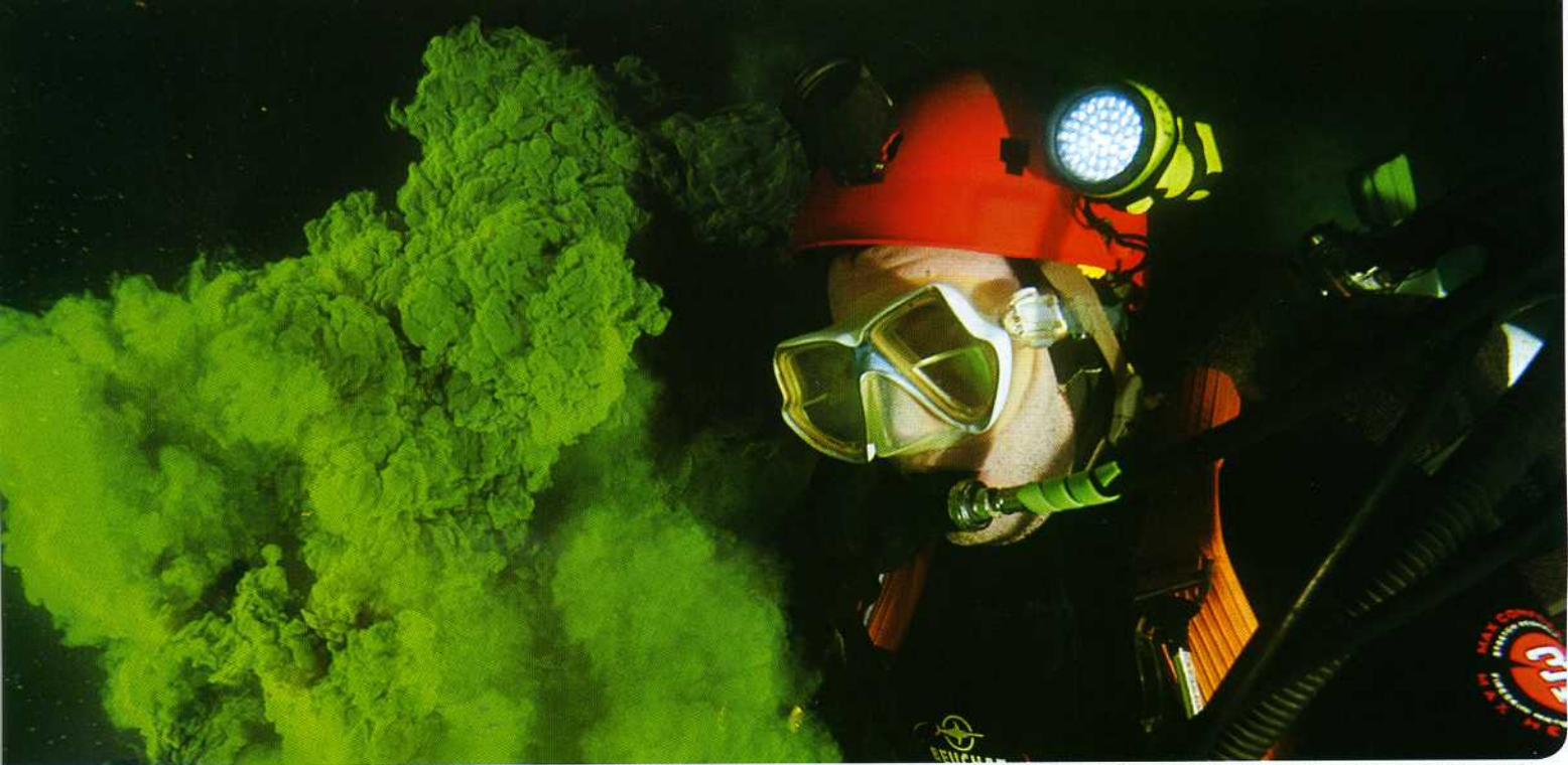
Le colorant : une méthode simple, pratique et amusante de mesurer le débit.
